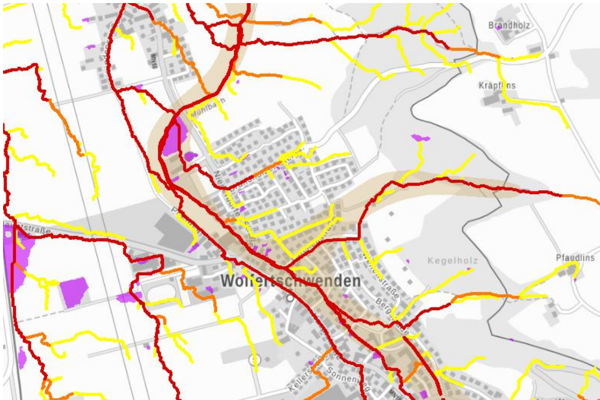
Abb. 8: Potentielle Fließwege bei Starkregen (Linien), Geländesenken und potenzielle Aufstaubereiche (pinke Fläche) und Wassersensible Bereiche (hellbrauche Fläche). Quelle: UmweltAtlas, LfU, Januar 2025.
